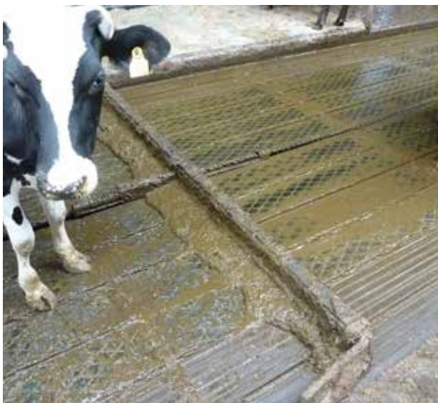
Figur 13. Jern mod gummigulv giver fedtet overflade pga. der efterlades en gødningshinde
