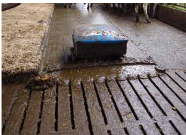
Figur 8. Skraberrobotten på fast gulv med aflevering for hver 25 m giver mulighed for, at programmere skrabereren til ikke at køre ved foderpladsen, når der lige er udfodret.
