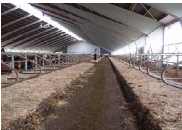
Figur 9. Fast gulv med afleveringer for hver 25 m. Skrabereren har ikke problemer med at rengøre gulvet
